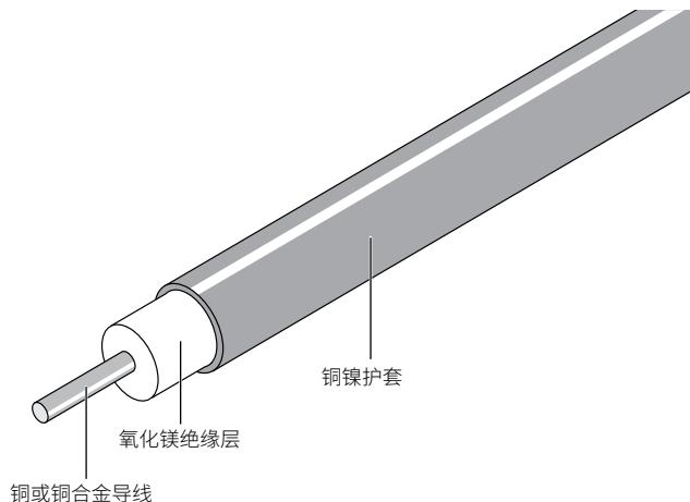
Raychem HDC/HDF铜镍系列矿物绝缘(MI)伴热线适用于危险区域，可广泛应用于石油天然气、化工及石化、发电、天然气存储等各种行业以及许多其他工业应用。带铜导线的铜镍护套伴热线(HDC)可以很小的电阻值供货，适用于供电点数量有限的长输管线应用，特别适用于超过聚合物绝缘(PI)系列伴热线性能的应用。HDC/HDF伴热线可用于暴露温度最高达400°C、典型输出功率最高达70 W/m的应用。HSQ伴热线以散装电缆供货，带有出厂预制尾端伴热组件，以确保连接的最佳品质。我们也提供一系列部件，用于伴热线的安装、连接及接线。
